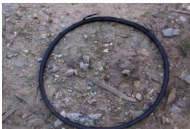
als Alexander am Morgen den Wagen kontrolliert, stellt er fest, daß der Keilriemen der Wasserpumpe dreht und lose ist. Wir versuchen dieses Problem ohne großen Aufwand zu beheben. Leider nicht möglich. Also Arbeitskleidung an und frisch ans Werk. Der Kühler und fast alle Keilriemen müssen ausgebaut werden, damit man den Übeltäter austauschen kann.
